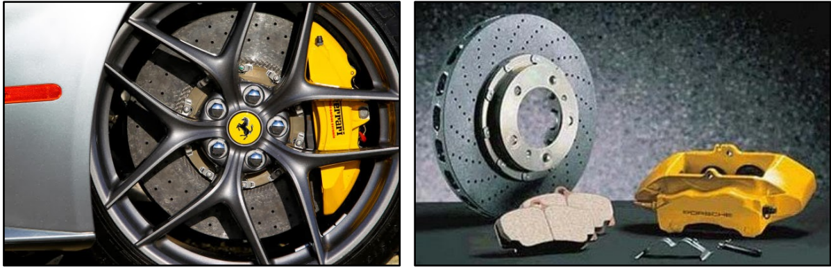
圖 22 碳/碳—碳化矽複合材料陶瓷煞車片組件
