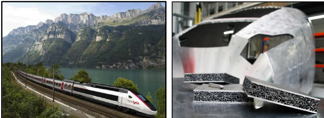
圖 18 法國 TGV 車體採用蜂巢夾層複合材料
