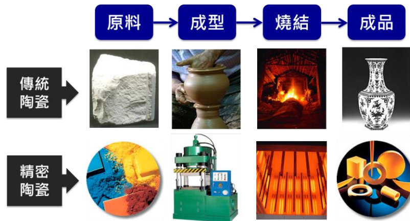
圖七 古今陶瓷製作過程的四個基本步驟。
